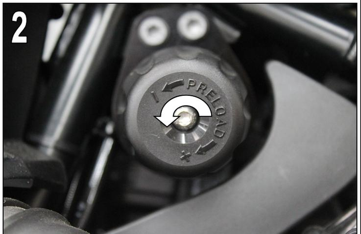
Befestigungsschraube des Original Handrads für die Dämpferverstellung mit einem passenden Torxschraubendreher lösen und Handrad abziehen.
