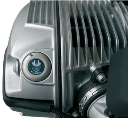
Hochwertiger Öldeckel / Ölstopfen aus Aluminium mit Emblem. An Stelle unseres Emblems können Sie auch ein BMW Emblem benutzen. Zum Öffnen und Schließen ist eine seitliche Bohrung vorgesehen, in die ein 3er Inbusschlüssel oder ein Torx T10 eingesteckt wird, der sich normalerweise im Bordwerkzeug befindet. siehe Werkzeuge
