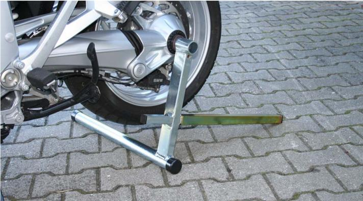
Das gummibeschichtete Rohr des Hecklifters wird seitlich in die hohlgebohrte Hinterradnabe eingeschoben. Durch Heruntertreten des Aufbockrohrs wird das Motorrad angehoben.
