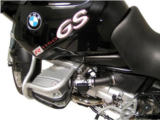
Diese Sturzbügel sind aus hochwertigem Stahl speziell für die BMW R1100GS & R1150GS hergestellt und passen sich sehr gut in die Optik der Maschine ein. Der Sturzbügel ist sehr stabil aufgebaut und sorgt für eine gleichmässige Verteilung der Kräfte, wodurch Sie und Ihr Motorrad optimal geschützt sind. Wird auch als Motorschutzbügel / Motorbügel / Motorschutz bezeichnet.
