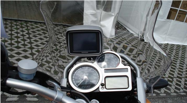
Durch unsere, aus dem Vollen gefräste und natur eloxierte, GPS Halterung ist kein Vibrieren des Navigationsgerätes möglich und die Route ist auch bei hohen Geschwindigkeiten perfekt sichtbar. Wird auch als Navihalterung bezeichnet.
