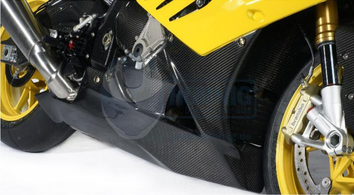
Dieser Motorspoiler ist aus hochwertigem Carbon hergestellt und mit UV-beständigem Klarlack beschichtet. Das komplette Produkt ist einteilig und speziell für die Rennstrecke hergestellt worden, daher hat es keine ABE bzw. Straßenzulassung. Für den originalen Vorschalldämpfer muss der Motor-Spoiler etwas ausgeschnitten werden. Zum Anbau wird der Verkleidungshalter Artikelnummer VHK.079.S1RAB.K benötigt.
