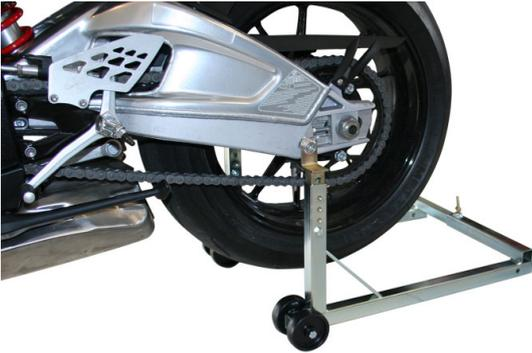
Der Hecklifter ist ideal geeignet zur Pflege, Überwinterung und Reparatur Ihrer Maschine. Aus robustem Stahlrohr 35x35mm gefertigt, galvanisch verzinkt und Qualität "Made in Germany". Ein großer Vorteil gegenüber den anderen Ständern ist, dass Sie die Höhe, um die Sie Ihre BMW S1000RR anheben, selbst bestimmen. Die 4 Rollen sorgen für einen sehr sicheren Stand!
