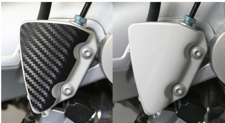
Dieses Pad ist zum Aufkleben auf den originalen Alu-Fersenschutz (der Fersenschutz verdeckt den Bremszylinder). Es ist in Carbon-Look oder in grau/silber erhältlich und schützt vor Kratzern und Farbabrieb vom Stiefel.
