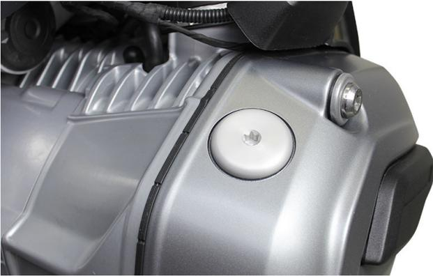
Absolut sicherer Verschluss für Ihren Zylinder, der einen Diebstahl des Ölstopfens nahezu unmöglich macht, da er nur mit einem Torx T45 (siehe Torx), der sich normalerweise im Bordwerkzeug befindet, zu öffnen ist. Durch sein Material und sein schlichtes Design passt sich der Öldeckel sowohl in praktischer als auch in optischer Hinsicht perfekt an die Gestaltung des Zylinders an.
