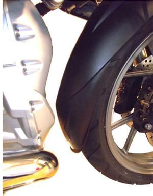
Diese aus ABS-Werkstoff tiefgezogene Verlängerung des originalen Kotflügels macht Schluss mit Problemen wie verdreckte Krümmer, Motorgehäuse, Steinschlagschäden und unnötige Wasseraufwirbelungen. Lieferung komplett mit Befestigungsmaterial (Spreiznieten und doppelseitiges Klebeband) für einen schwingungsfreien und festen Sitz.
