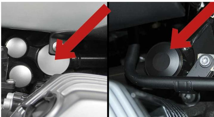
Diese Abdeckungen für das offene Rohr der Motorbefestigung sind aus robustem Aluminium hergestellt und silber eloxiert. Die 4 Rahmenabdeckungen werden seitlich vor und hinter dem Zylinder, links und rechts angebracht. Wird auch als Deckel / Abdeckung / Abdeckstopfen / Abdeckkappe / Rahmenstopfen bezeichnet. Die Rahmenabdeckungen werden jeweils im Set (4 Stück) geliefert.
