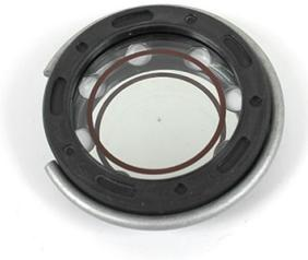
Sie können diese Ölstandskontrolle gegen Ihre originale Ölstandskontrolle bzw. das Ölstandsauge austauschen, wenn dieses vergilbt oder kaputt ist. Der Austausch erfolgt am besten während des nächsten Ölwechsels. Unter Umständen muss das Glas des alten Ölstandsauges beschädigt werden, um es leichter entfernen zu können.
