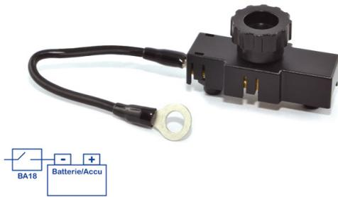
Vollisolierter Batterie-Trennschalter in Minibauform für Motorräder, Roller und Quads zum Abtrennen der Batterie vom Bordnetz. So kann verhindert werden, dass ständige Verbraucher wie z.B. Uhr, Speicherungen, Wegfahrsperrung und USB-Steckdosen die Batterie in längeren Standpausen entladen.
