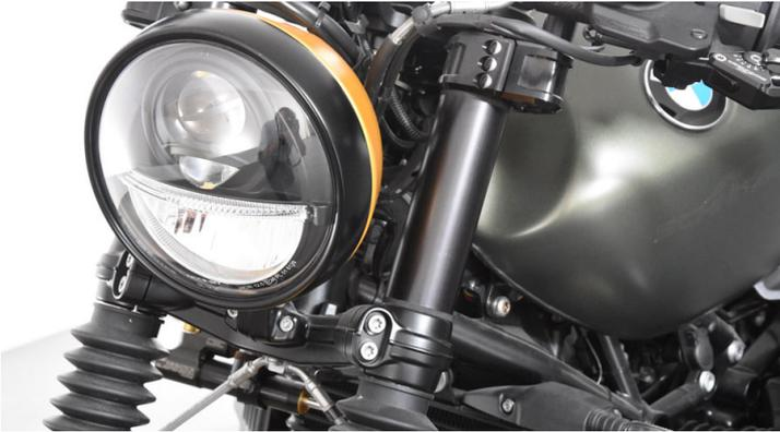
Diese Standrohrcover für die BMW RnineT Scrambler, Pure & RnineT /5 werten die Optik Ihres Motorrads deutlich auf und sorgen darüber hinaus für einen erhöhten Schutz der Standrohre.
