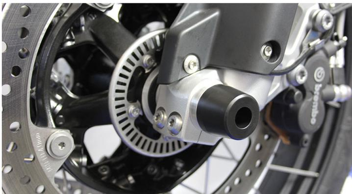
Diese Sturz pads für Gabelenden sind aus CNC gedrehtem Kunststoff (POM) hergestellt. Die Halterung ist aus CNC verarbeitetem Aluminium eloxiert.
