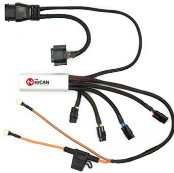
Mit dem HEX ezCAN GEN II Zubehörmanager können Sie Zubehörgeräte wie zusätzliche Scheinwerfer, eine Hupe, Notfallbremsleuchten, etc., schnell und einfach hinzufügen und konfigurieren ohne Kabel durchtrennen zu müssen.
