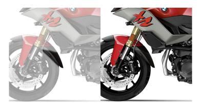
Diese aus ABS-Werkstoff tiefgezogene Verlängerung des originalen Kotflügels macht Schluss mit Problemen wie verdreckte Krümmer, Motorgehäuse, Steinschlagschäden und unnötige Wasseraufwirbelungen. Lieferung komplett mit Befestigungsmaterial (Spreiznieten und doppelseitiges Klebeband) für einen schwingungsfreien und festen Sitz.
