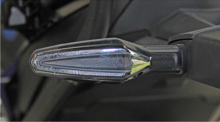
LED Blinker vorne für alle BMW R1300GS & Adventure, bei denen die LED-Blinker NICHT in den Handprotektoren integriert sind!
