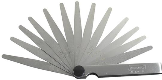
Dieser Fühlerlehrensatz wird in einer vernickelten Schale geliefert. Die Blätter sind konisch zulaufend. Federharte, gleichmäßig breite Stahlblättchen mit deutlicher Beschriftung. Zusammenklappbar durch Nietgelenk. Gefertigt aus Stahl, Genauigkeit T2.
