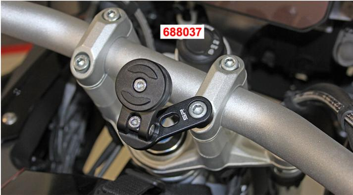
Der SP Connect Bar Clamp Mount Pro ist die perfekte Möglichkeit, um das Smartphone sekundenschnell, flexibel und intuitiv am Motorrad zu befestigen. Der Bar Clamp Mount Pro kann an der Lenkerklemme montiert werden und bietet einen schwenk- und drehbaren Kopf, um das Smartphone optimal positionieren zu können. Das Smartphone kann sowohl im Hoch- als auch im Querformat fixiert werden.
