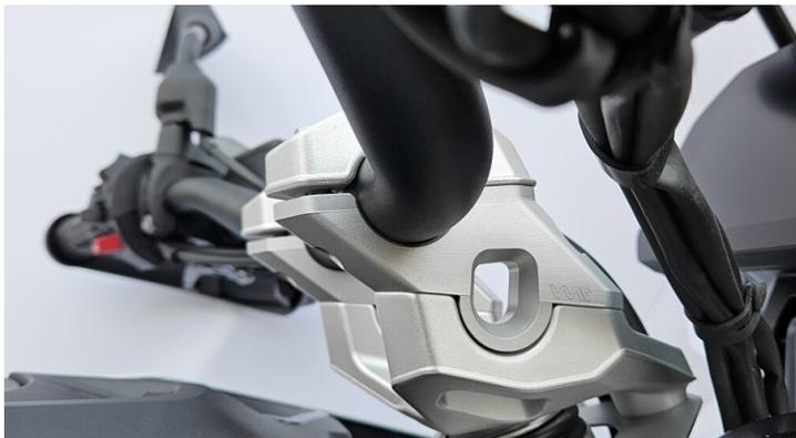
Lenkererhöhung mit Versatz: 30mm höher & 33mm zurückversetzt
