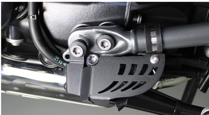
Schutzabdeckung aus Aluminium für den Sicherheitsschalter am Seitenständer.
