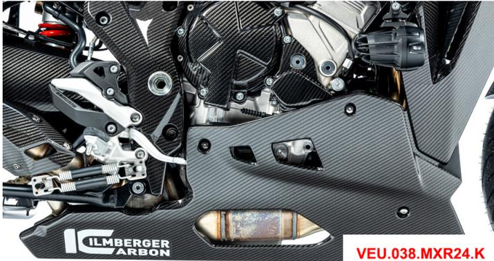
Dieser Motorspoiler ist aus hochwertigem Carbon hergestellt und mit UV-beständigem Klarlack beschichtet. Das komplette Produkt ist einteilig und speziell für die Straße hergestellt worden. Der Motorspoiler kann mit dem originalen Auspuff kombiniert werden und er ist seitenständertauglich und hauptständertauglich.
