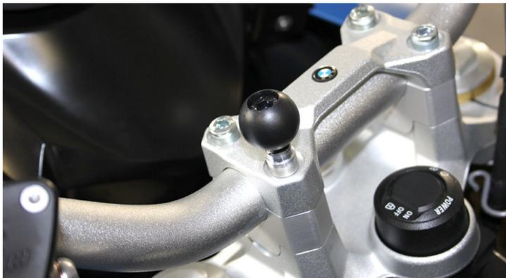
Die Schraube wird mit der GPS-Kugel in die Gabelbrücke eingeschraubt. Wird auch als Navihalterung bezeichnet. Schraubenlänge 55/60/65mm, M8 Gewinde.
