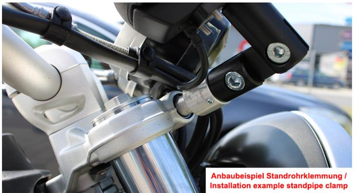
Anbaubeispiel Standrohrklemmung / Installation example standpipe clamp
